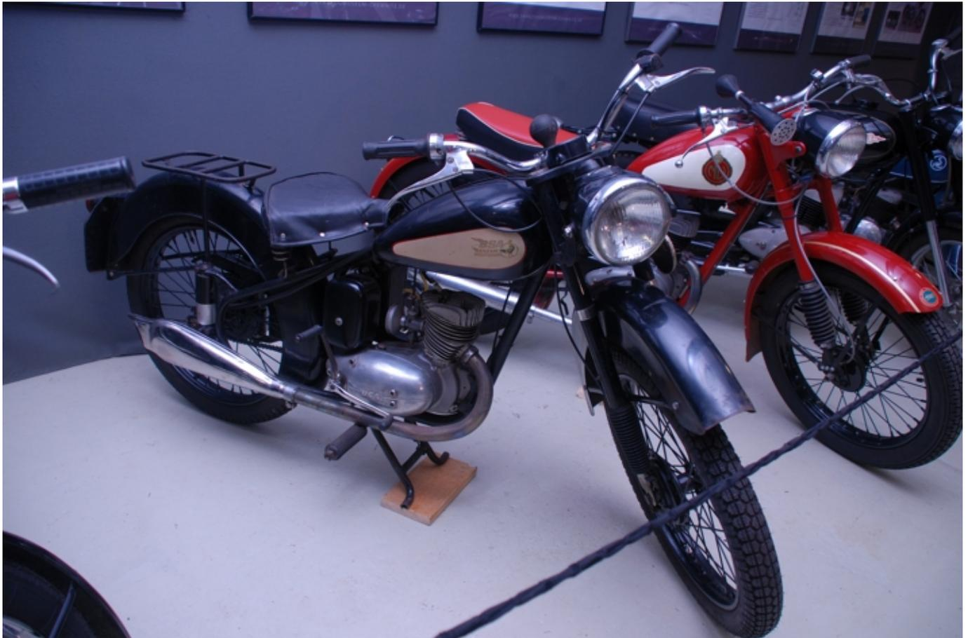
Eine BSA Bantam D1 von 1950 aus Großbritannien. (Mit seitengespiegeltem Design, weil sie von rechts angetreten wird.)
